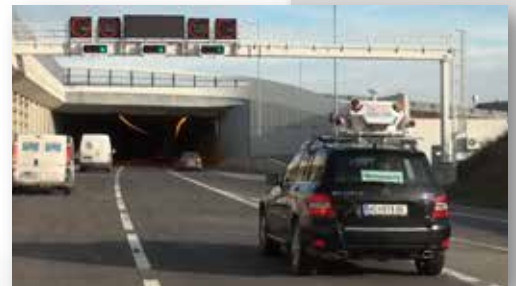
RIEGL VMX-1HA картографирование скоростной автомагистрали
