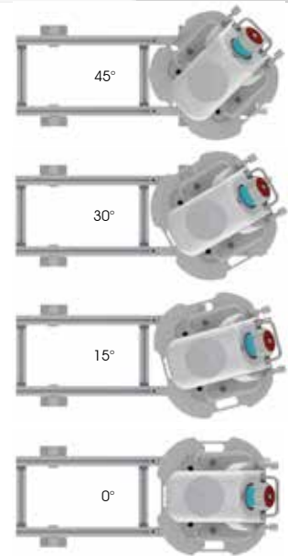
360° вертикальный сектор сканирования при одном проезде
