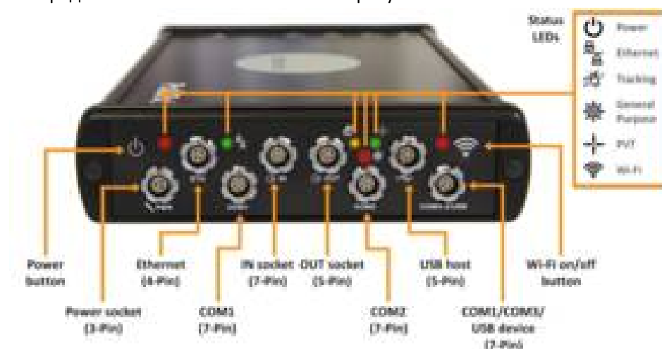
Рис 2-1: Передняя панель PolRx5 – PolRx5S - PolRx5TR
