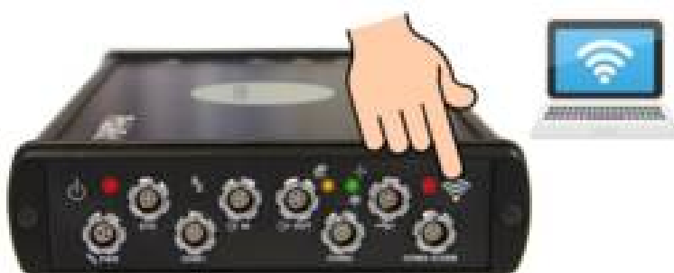
Рис 3-6: Нажмите на кнопку WiFi на передней панели, чтобы включить модем WiFi. Когда модем активен, красный светодиод WiFi будет гореть.
